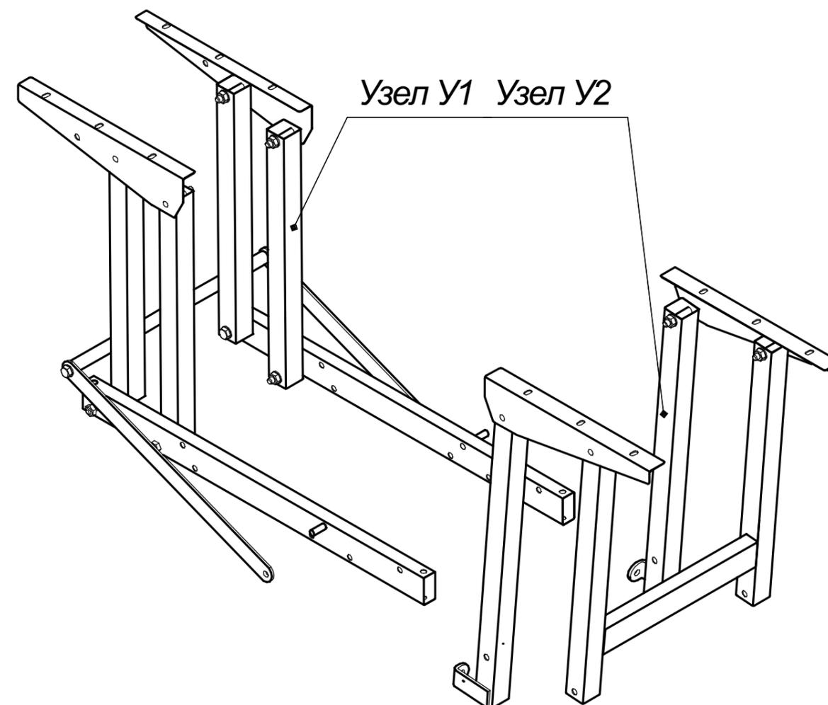
1.1 Зафиксировать рычаги узла У2 на основаниях болтами М8х65, проставив шайбы 8 (рисунок 2). Между рычагом и основанием устанавливается увеличенная шайба 8. Закрутить самоконтрящиеся гайки М8, обеспечив при этом подвижность рычага стяжки.
